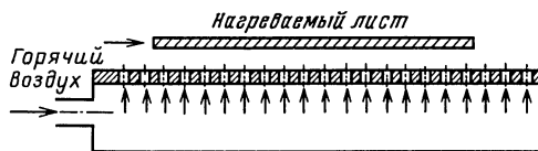
Рис. 9.3. Схема термообработки листовых изделий на «воздушной подушке»
